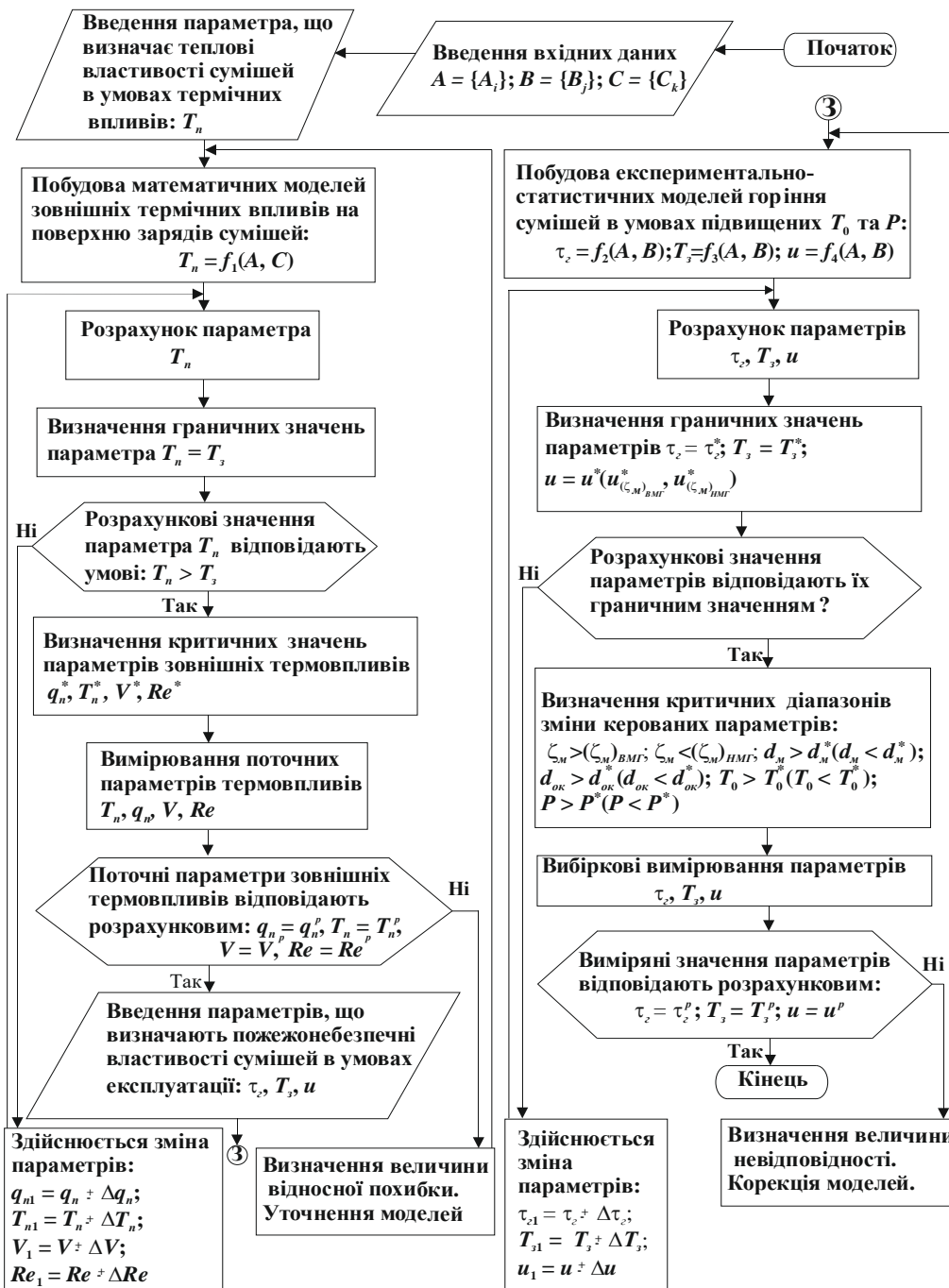
Рисунок 3 – Алгоритм визначення критичних значень параметрів зовнішніх термічних дій (теплових потоків та часів їх дії, швидкостей обдуву потоком повітря та критеріїв Рейнольдса) на піротехнічні вироби з зарядами сумішей, що дозволяє попереджати можливі передчасні їх спрацювання та пожежонебезпечні руйнування у процесі експлуатації: A – параметри зовнішніх термічних дій; B – керовані технологічні параметри сумішей; C – механічні, теплофізичні та фізико-хімічні характеристики зарядів сумішей
