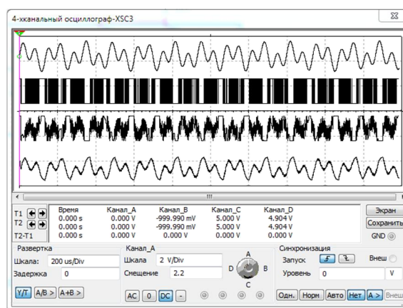
Рисунок 8 – Осцилограми роботи дельта-сигма АЦП (схема наведена на рисунку 6)
