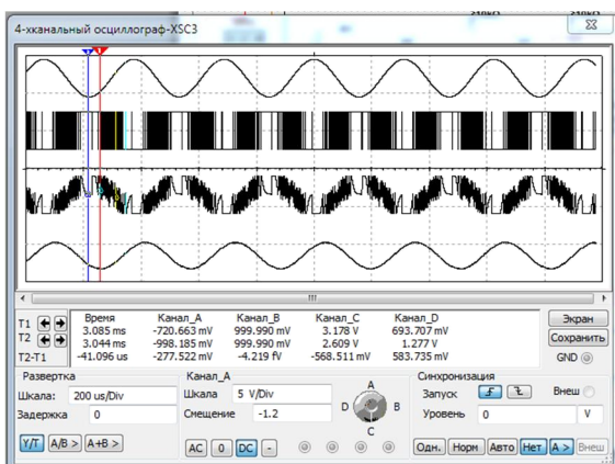
Рисунок 7 – Осцилограми роботи дельта-сигма АЦП (схема наведена на рисунку 6)
