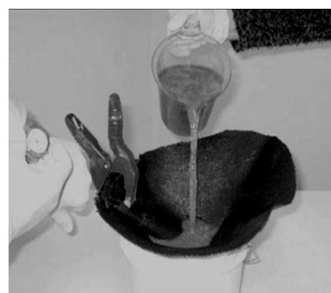
Рисунок 9 – Фільтрація в геотекстильному мішку протягом 10 днів
