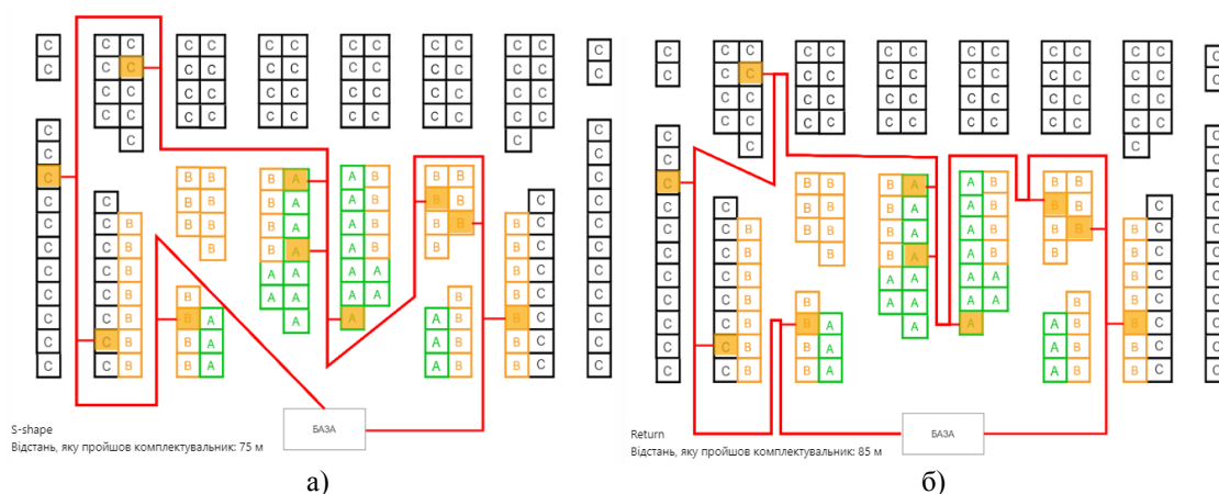
Рисунок 10 – Маршрути руху з використанням: а) S-Shape; б) Return методів
