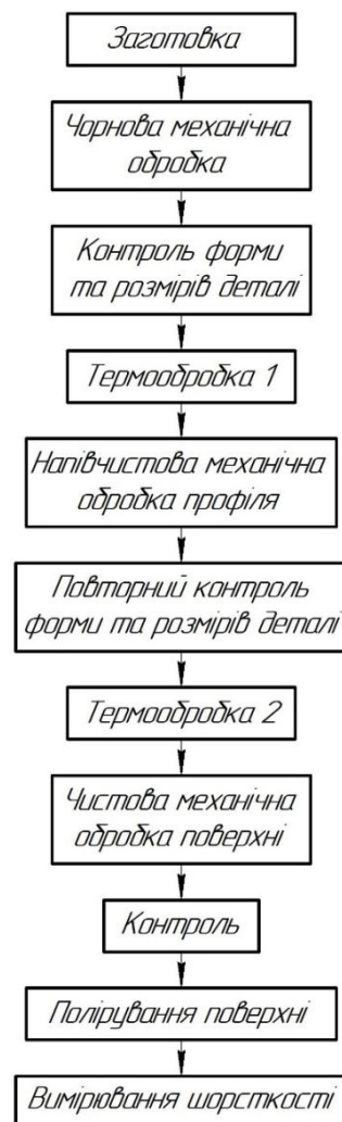
Рисунок 1 – Спрощена схема виготовлення ротора з алюмінієвих сплавів Д16 та В95 за заданою шорсткістю
