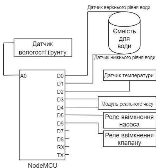
Рисунок 2 – Загальна схема мікроконтролерної системи
