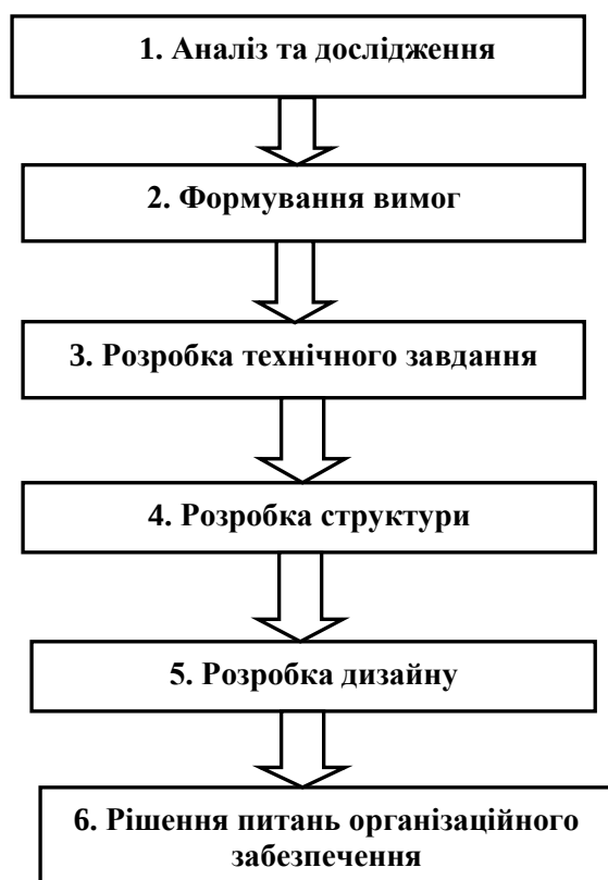
Рисуюнок 1 – Схема процесів проектування Web-орієнтованих інформаційних систем
