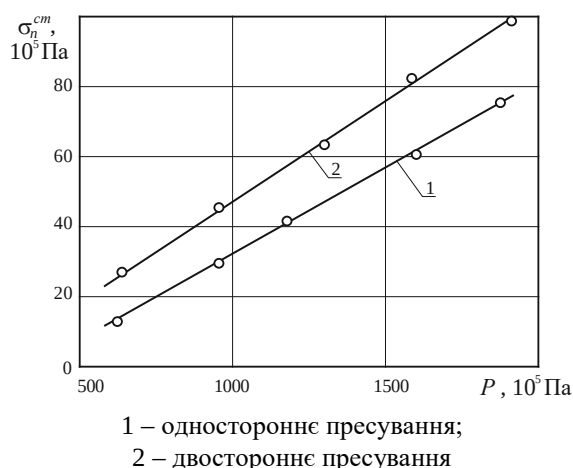
Рисунок 3 – Залежність межі міцності на стиснення суміші на основі МПФ – 2 (65 %) та \text{NaNO}_3 (30 %) від виду пресування (зразки діаметром 9 \cdot 10^{-3} \text{ м} )
