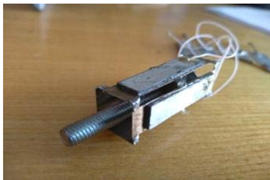
Рисунок 6 – Експериментальний зразок розробленого п'єзоелектричного двигуна
