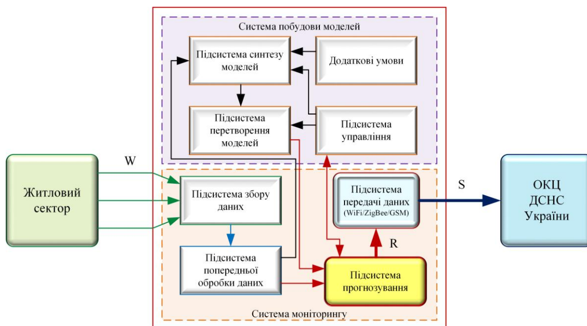
Рисунок 1 – Структурна схема комп'ютеризованої системи для реалізації методу прогнозування передумов виникнення пожеж у житловому секторі
