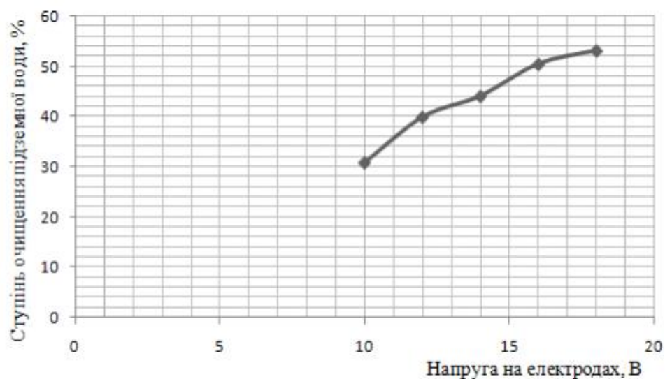
Рис. 3. Графік залежності ступеня очищення підземних вод від напруги в процесі електроактивації.
