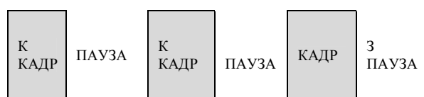
Рис. 1. Диаграмма работы стандартного канала IEEE 802.3
