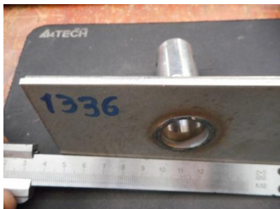
Рисунок 6 – Фотографія з'єднання типу «пластина-труба» після лазерного зварювання
