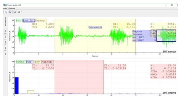
Рисунок 3 – Зовнішній вигляд вікна програми BiTronics Studio
