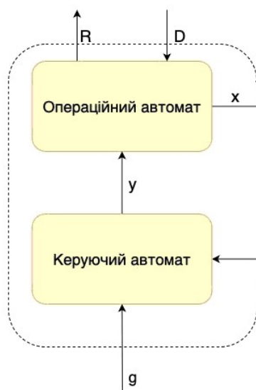
Рисунок 1. Представлення цифрового операційного пристрою як комбінації операційного та керуючого автоматів
