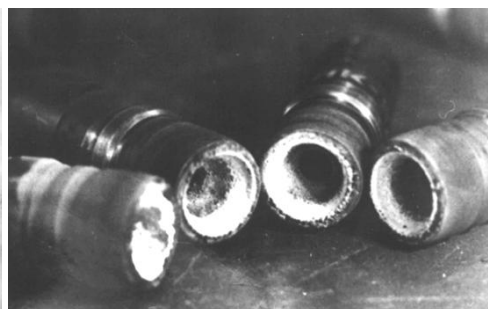
Рисунок 2 – Кінокадри зйомки загальної картини пожежонебезпечних руйнувань піротехнічних ІЧ-випромінювачів на основі зарядів нітратно-титанових сумішей при зовнішніх термічних діях
