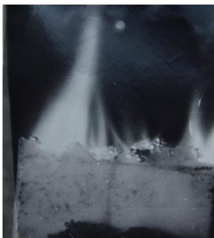
(мікрозйомка процесу горіння здійснювалася кінокамерою СКС-1М (швидкість зйомки – 3000...5000 кадр/с))
