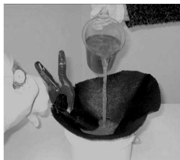
Рисунок 9 – Фільтрація в геотекстильному мішку протягом 10 днів
