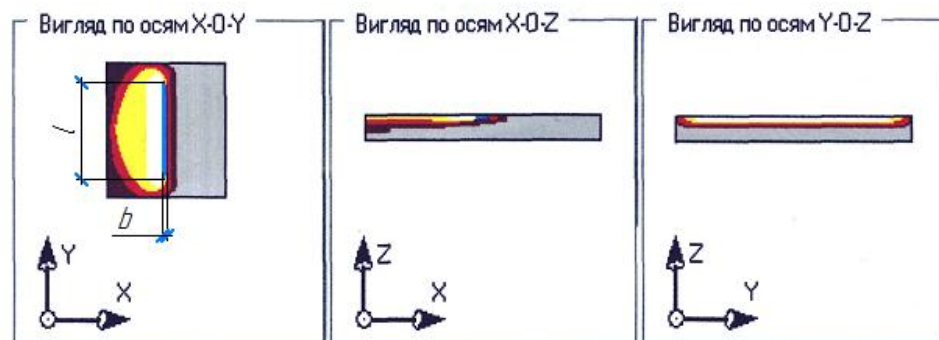
Рис. 1. Змодельований розподіл температурних полів в фотопластині за координатами x, y, z , в залежності від режимів обробки рухомих стрічковим електронним потоком:
