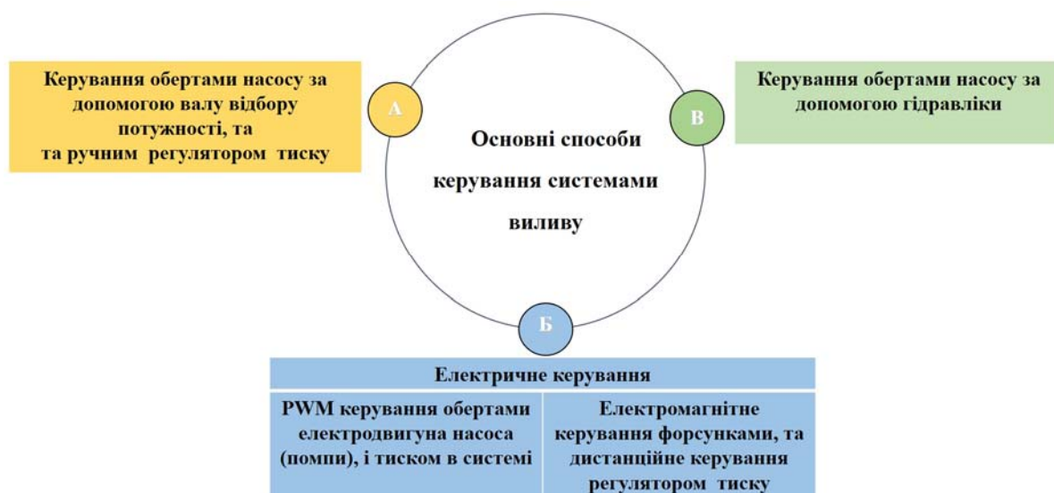
Рисунок 2. Класифікаційна схема основних способів керування системами виливу добрив
