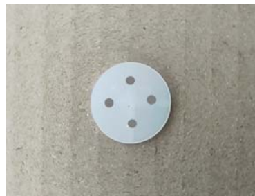
Рисунок 7. Дозуюча шайба з однаковими отворами
